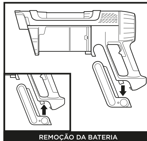
REMOÇÃO DA BATERIA
