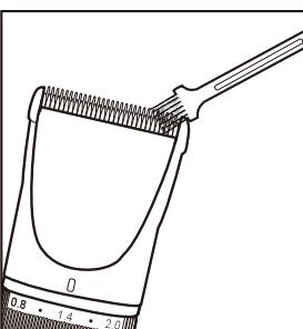
2. La lame peut être retirée pour le nettoyage.
