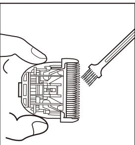
La lame mobile peut être repoussée, puis nettoyez les poils entre la lame mobile et la lame fixe.
